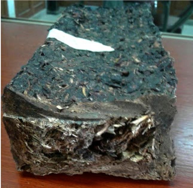
Figura 4. Corte de briqueta de orujo de manzanas.
